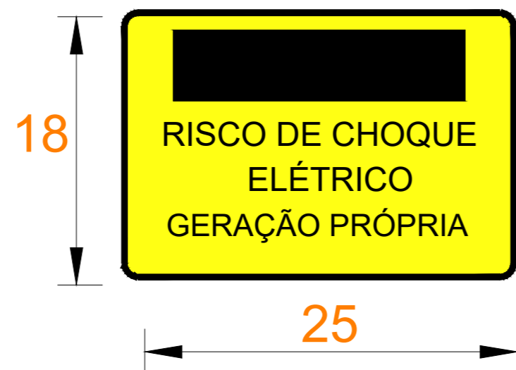
08 Detalhe: Placa de Advertência SEM ESCALA
